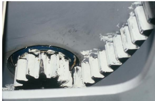
Klüberplex AG 11-461 e 462 sono lubrificanti adesivi bianchi, a base di olio minerale, lubrificanti solidi bianchi ed un ispessente al sapone complesso di alluminio.
